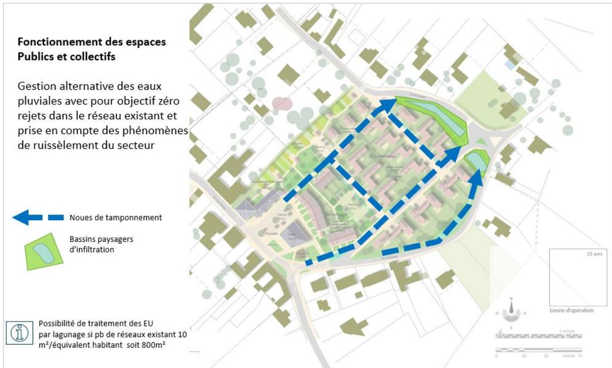
Figure 20 : Principes de gestion alternative des eaux pluviales, source : ANTEA GROUP
