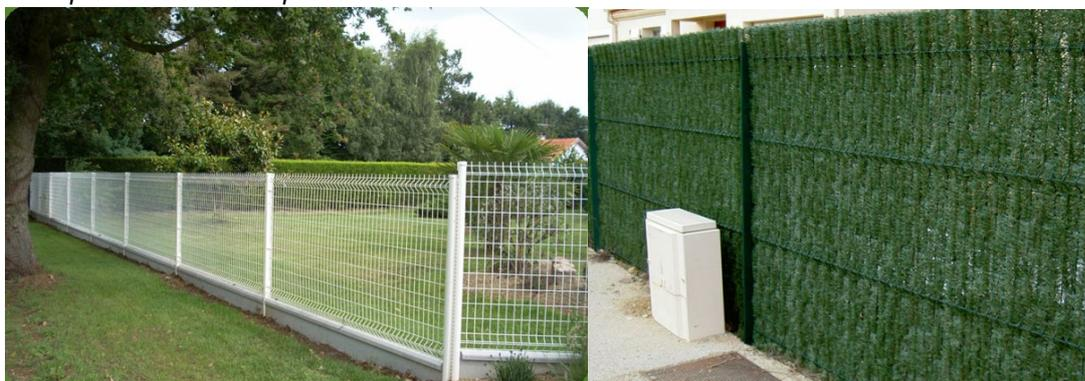
**En zones inondées constatées**, secteurs concernés par un risque de remonté de nappe (aléa fort à nappe sub-affleurante), **les clôtures devront être hydrauliquement neutres (pas de plaque béton en soubassement).**
