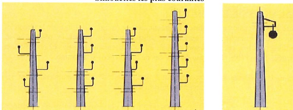
Figure 1 : Réseau électrique BT nu et isolé
