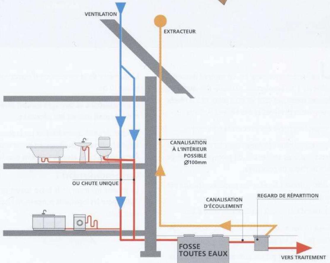
SCHÉMA DE PRINCIPE DE VENTILATION
