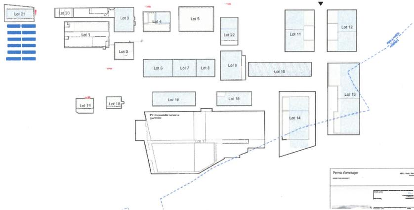
À l'échelle du site, la surface totale des toitures est de 55 500 m<sup>2</sup>. Parmi elles, 22 400 m<sup>2</sup> sont destinés à recevoir des panneaux photovoltaïques, ce qui correspond aux 40 % exigés par le règlement du PLU.
