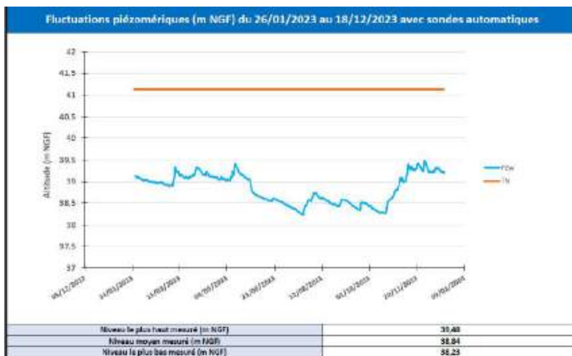
Figure 63. Fluctuations piézométriques au droit du piézomètre PZw
