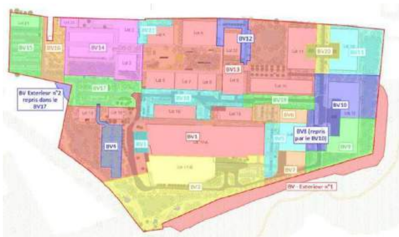
Figure 12 : Synoptique des bassins versants – Source : Permis d'aménager
