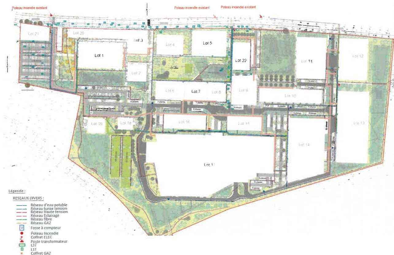
Tous les réseaux divers seront posés en tranchée commune ouverte par l'aménageur à l'intérieur de l'opération et se raccorderont à ceux existants à proximité de l'opération.
